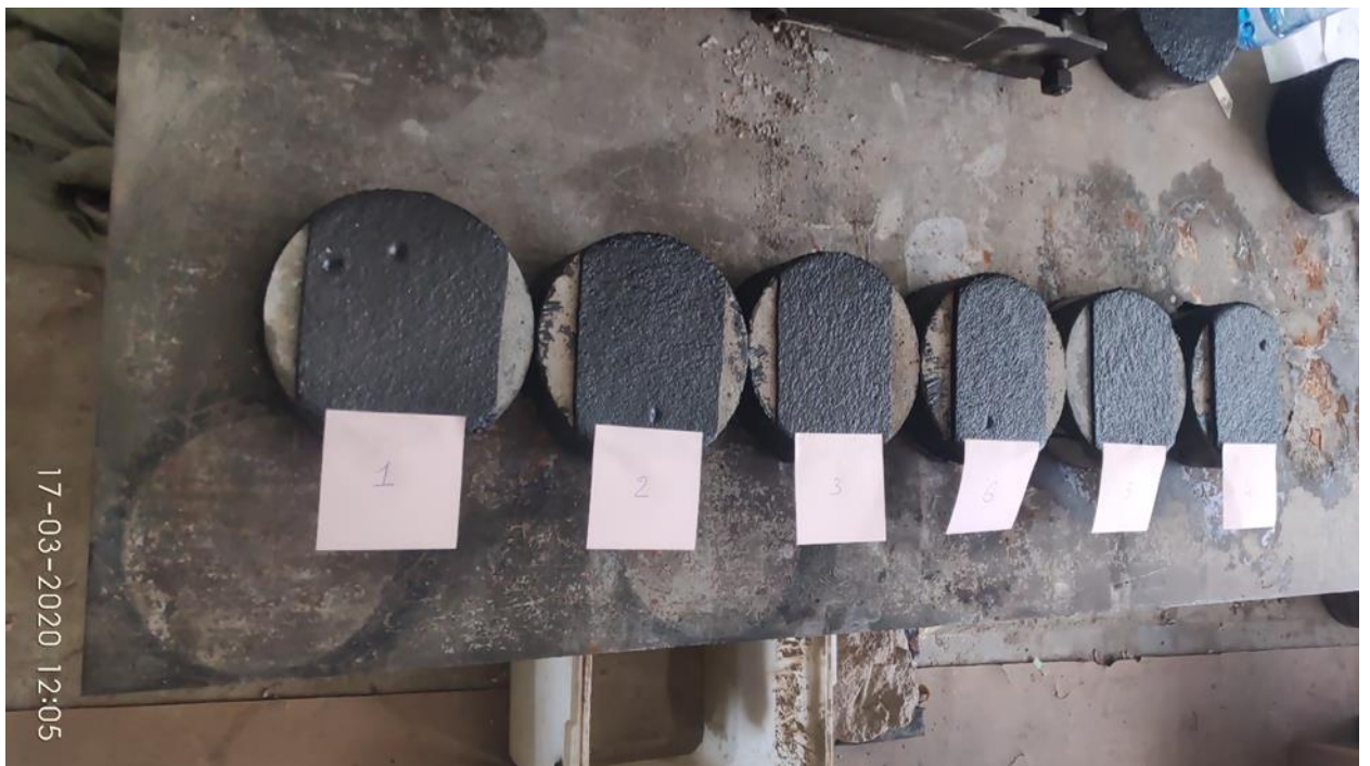
Рис. 3.1. Общий вид образцов до (сверху) и после напыления (снизу) гидроизоляции (эмульсии битумной двухкомпонентной Spray-Тес Base В-250)
