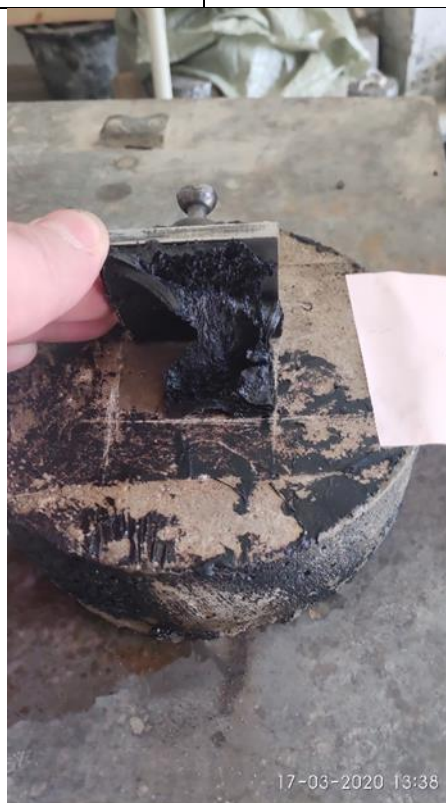
Рис. 3.2. Испытание образца 1 с напылением гидроизоляции после выдержки в климатической камере
