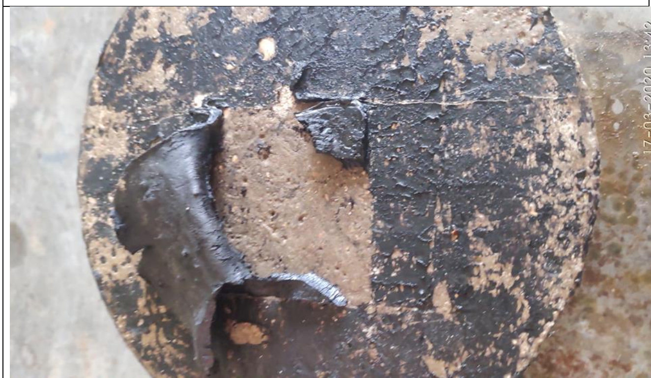
Рис. 3.3. Испытание образца 2 с напылением гидроизоляции после выдержки в климатической камере
