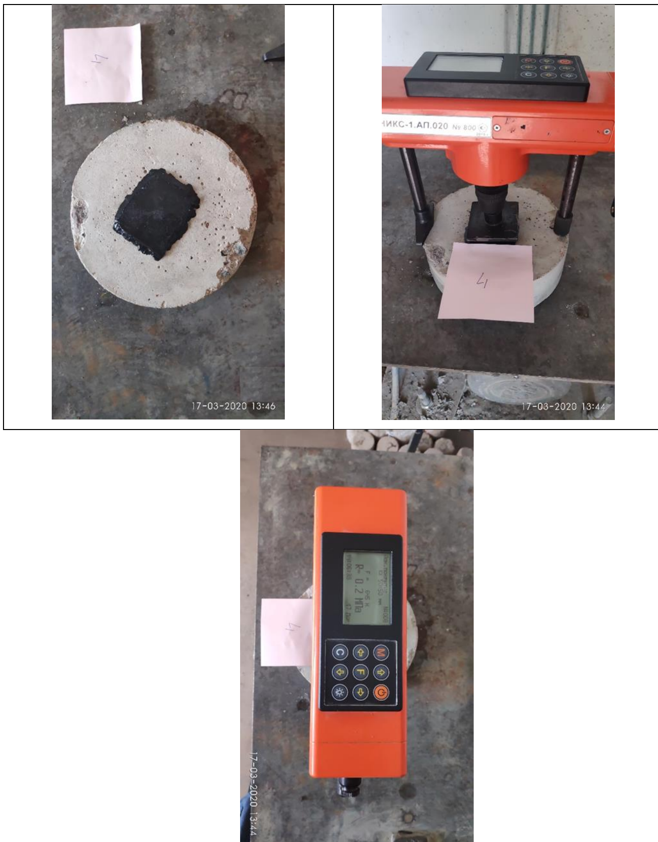
Рис. 3.4. Испытание образца 4 с напылением гидроизоляции после выдержки в климатической камере
